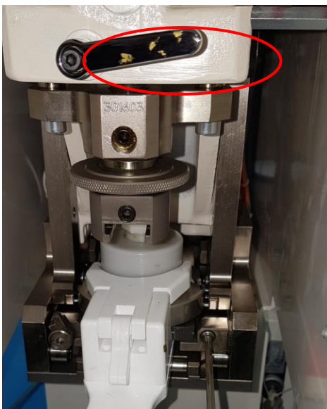
4.2.12 Apretar la perilla sujetadora del anillo de presión
