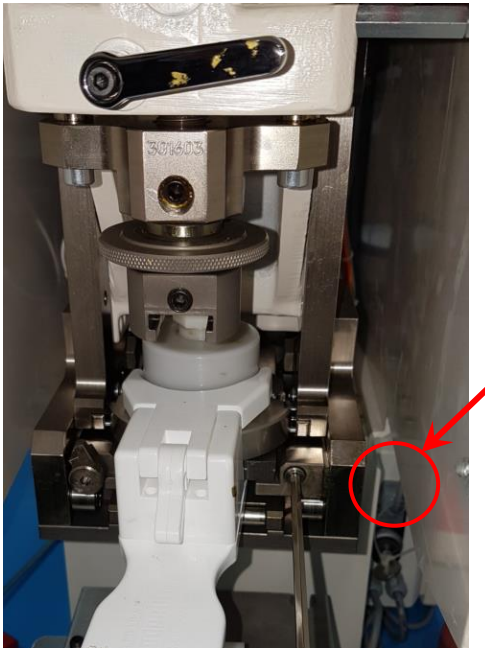
4.2.10 Apretar el tornillo de presión del cliché
