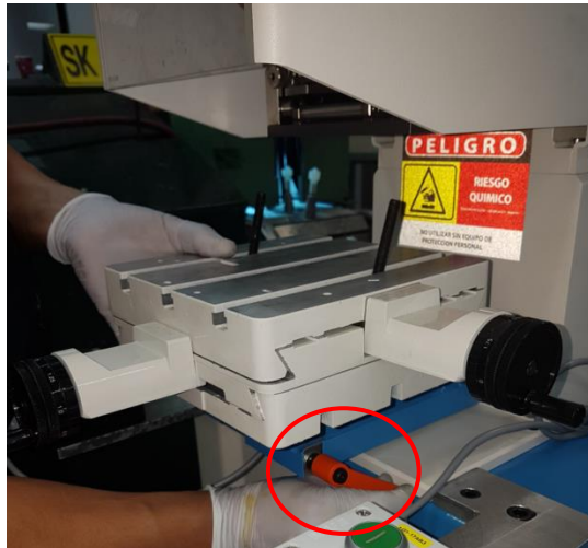
4.4.1 Aflojar la perilla y bajar la placa hasta el tope
