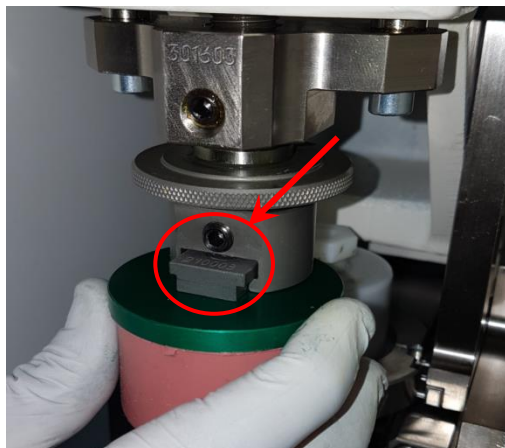
4.3.3 Colocar el PAD en el montaje de la máquina asegurando que embonen las ranuras
