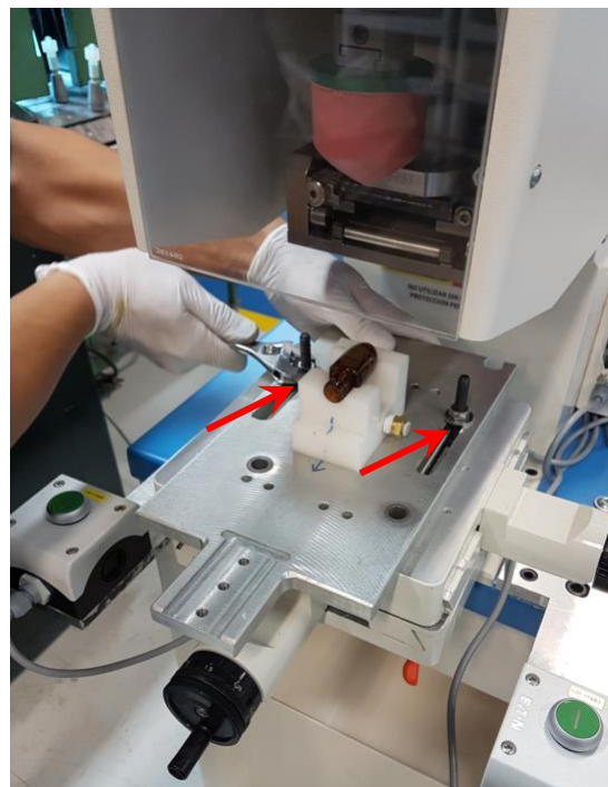
4.4.2 Colocar el fixture en la placa y apretar los tornillos
