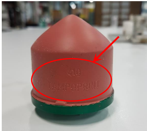
4.3.1 Seleccionar el PAD que se requiere mediante el número de identificación
