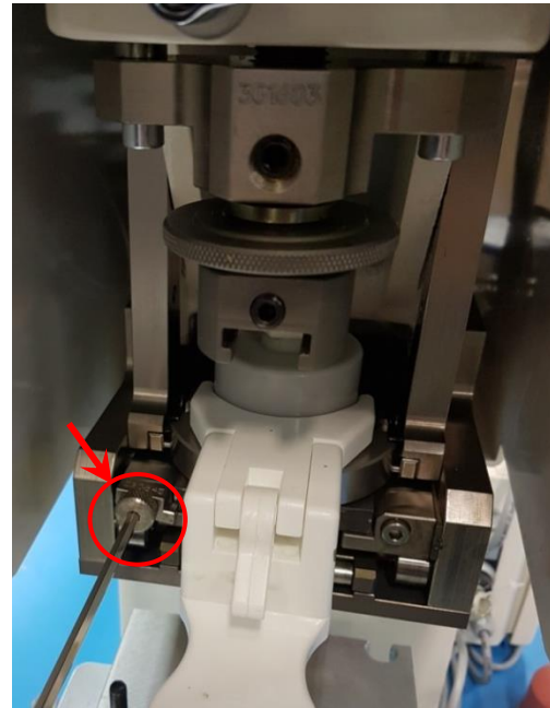
4.2.11 Apretar el tornillo de sujeción del cliché
