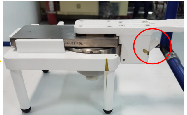
4.2.7 Colocar el seguro en las pinzas para sostener el ensamble
