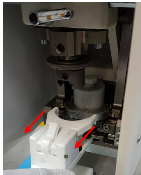
4.2.13 Liberar el seguro de la pinza y retirarla con cuidado de la maquina
