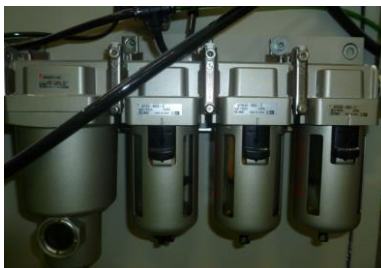
Filtros de aire que constituyen las unidades de mantenimiento.
