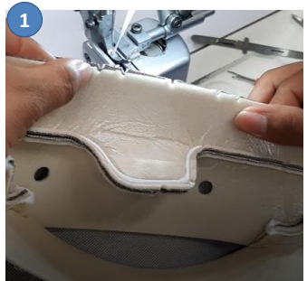
1. Tomar la pieza del bottom 3 y juntarlo sobre puesto con el insert de la pieza (todos los piquetes deben de coincidir).
