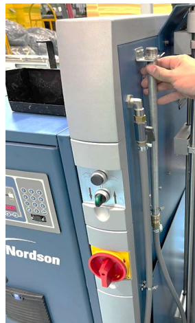
Tomar la manguera y enrosarla en donde se retiró el pivote
