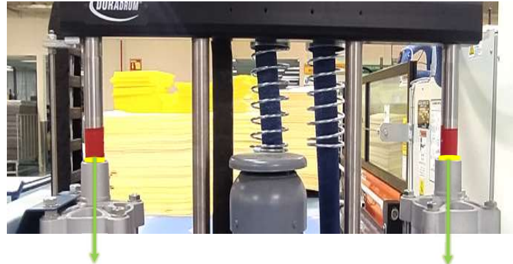
Estas marcas nos indican que ya es necesario cambiar el tambo de adhesivo.
