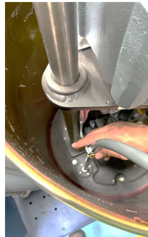
Tomar la manguera y enrosarla en donde se retiró el pivote
