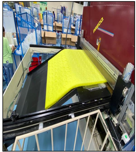
Salida de material, revisar que el material salga completo y no se atore dentro de la máquina
