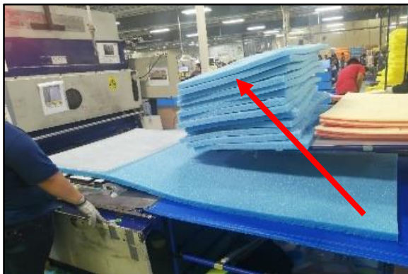
Operadora de maquina deberá colocar el material cortado en área asignada
