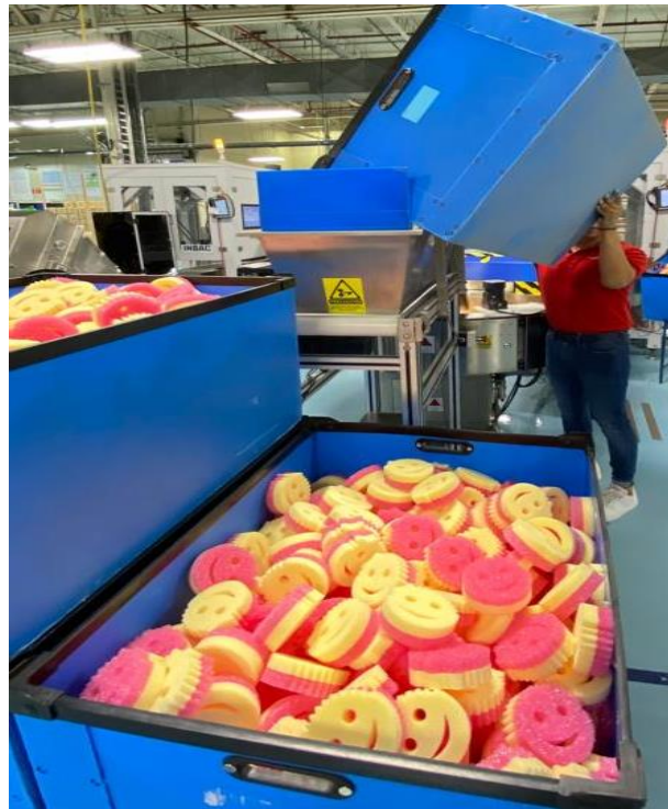
Operador llena la tolva con las piezas
