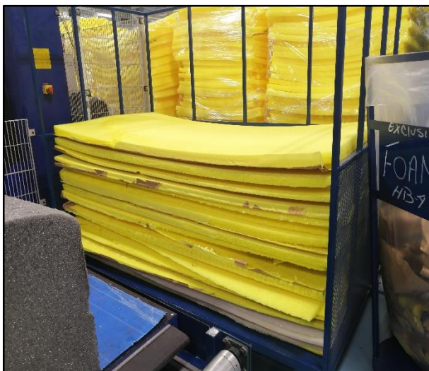
Contenedor de scrap para máquinas horizontales y laminadora BLACK BROS, una vez lleno será llevado por el personal de la compactadora para su siguiente proceso.
