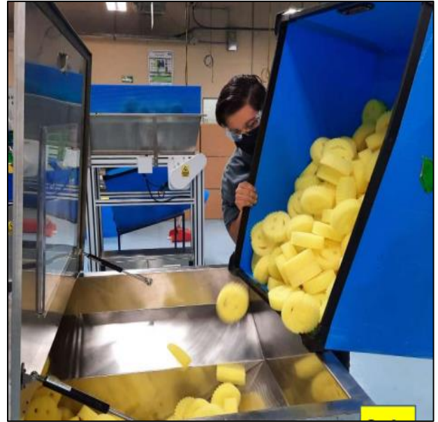
Operador vacía las piezas en la tolva
