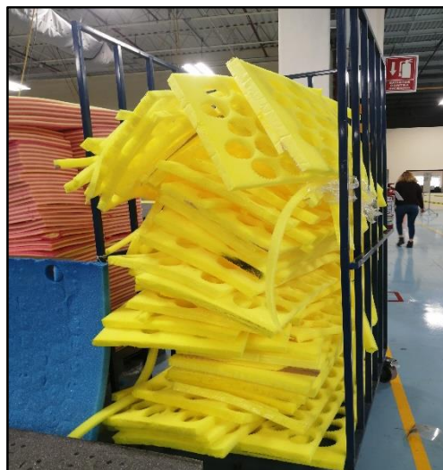
Contenedor de scrap para máquinas sunkist, este contenedor es llevado a la compactadora por el materialista del área.
