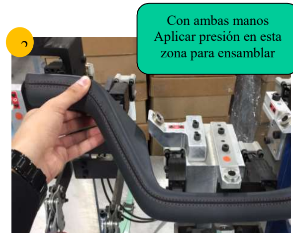
Presionar el lado izquierdo de la pieza para ensamblar los clips
