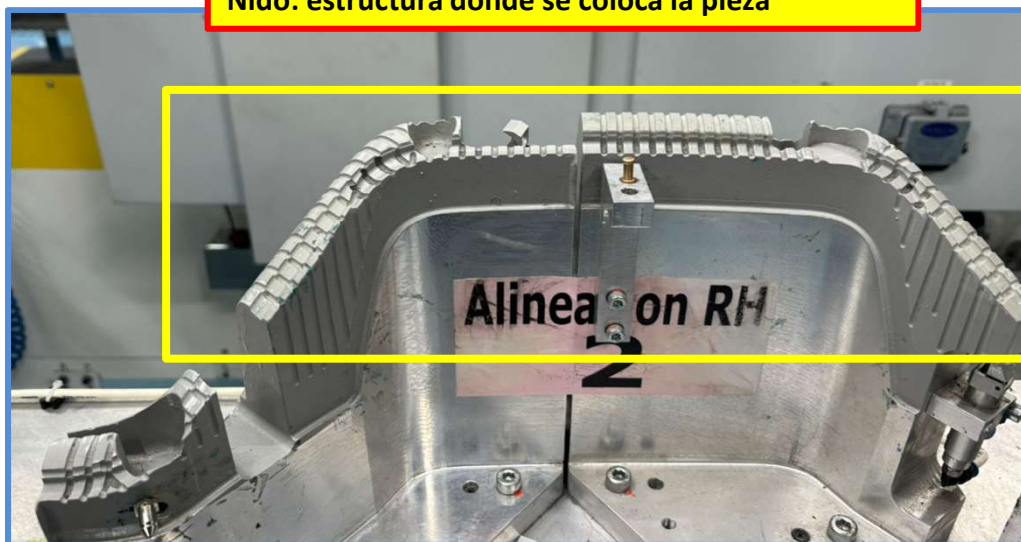
Nido: estructura donde se coloca la pieza
