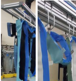
Colocación de piezas en conveyor de horno de secado.
