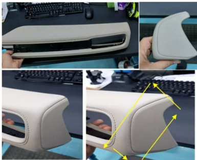
Pieza se debe de mover (“charolear”) buscando que la pieza no presente bump como en la imagen N.G.
