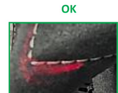
Las puntadas rectas van en la cara frontal de la pieza y las inclinadas en el lateral. No deberá de quedar alguna puntada sobre el borde del sustrato.
