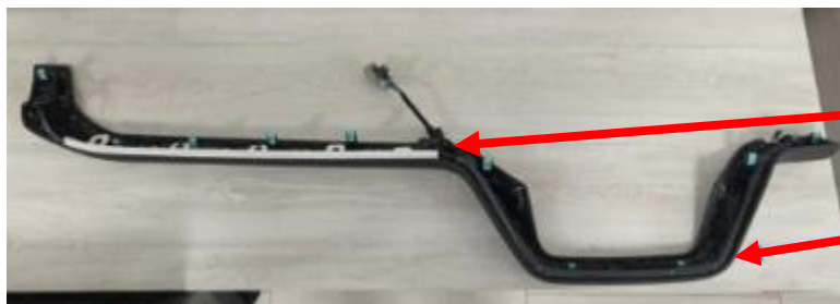
Ruteo debe ir por la parte trasera del plástico de luz
