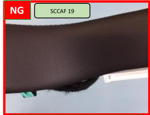
Cable de luz fuera de la pieza, Condición no aceptable NG
