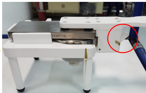
4.2.7 Colocar el seguro en las pinzas para sostener el ensamble
