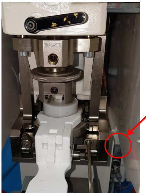
4.2.10 Apretar el tornillo de presión del cliché
