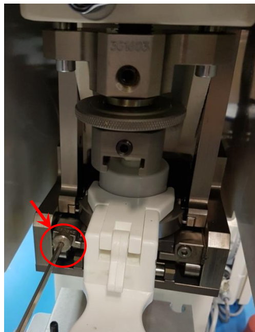
4.2.11 Apretar el tornillo de sujeción del cliché
