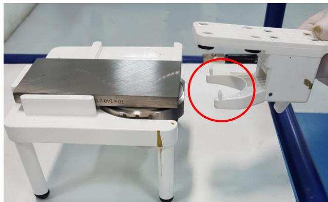
4.2.6 Sujetar el ensamble de cliché y recipiente con tinta con la pinza
