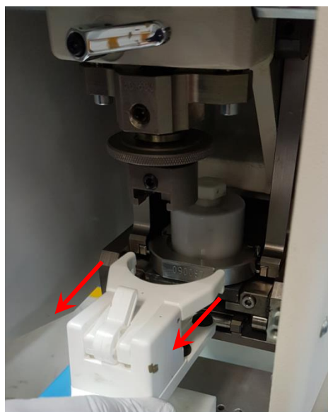
4.2.13 Liberar el seguro de la pinza y retirarla con cuidado de la maquina
